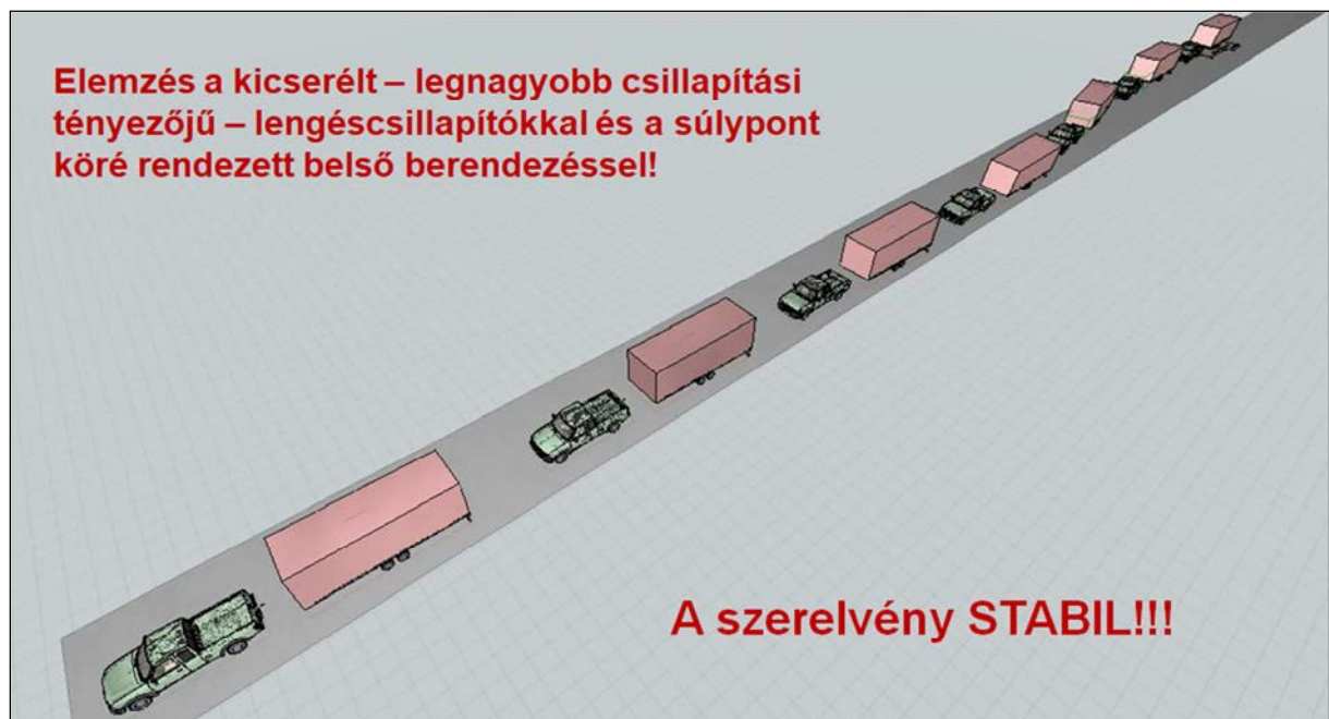
A módosított lakóutánfutó stabilitás-vizsgálatának eredménye.
