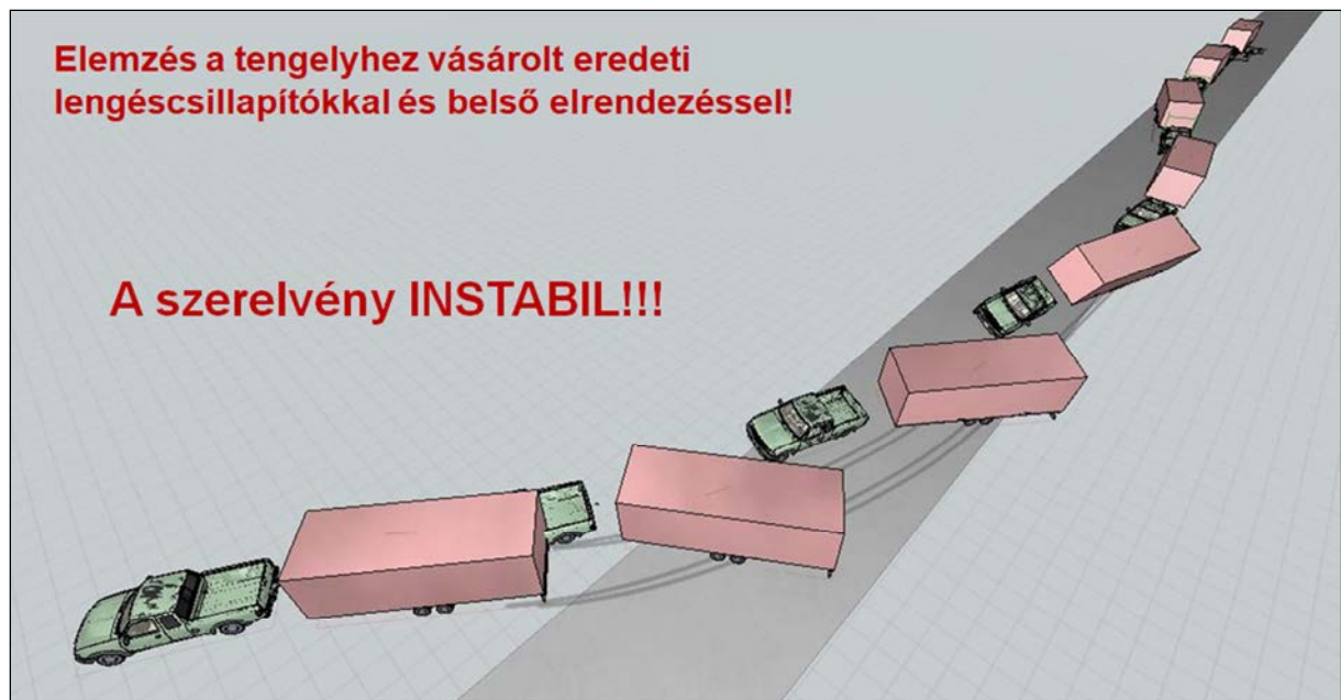
A lakóutánfutó stabilitás-vizsgálatának eredménye.
